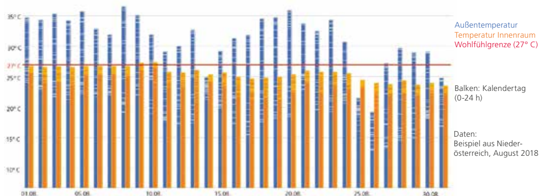
Grafik: Temperaturentwicklung Außentemperatur versus Innenraumtemperatur (Wohnraum, Erdgeschoß, textile Screens mit Soltis 92-2047)
